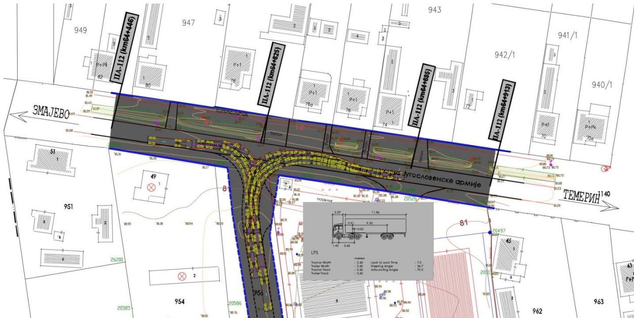
Слика бр.1: Саобраћајно решење прикључка са приказом криве трагова меродавног возила.
